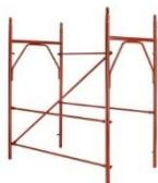
Trattasi dell'installazione di ponteggio costituito da telai prefabbricati fissi, cioè di forma e dimensioni predefinite, posti uno sull'altro a costituire la stilata, collegata alla stilata attigua tramite correnti o diagonali. Il sistema a "telaio prefabbricato" si presenta nei due schemi strutturali a portale e ad H, con due tipologie di attacchi: a perni e a boccole. Viene utilizzato per eseguire lavori ad altezza superiori a mt. 2,00.
